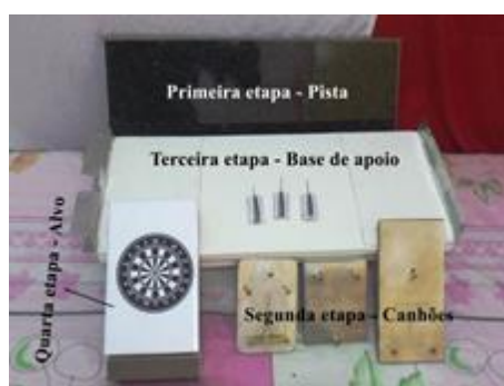
Figura 1: Etapas de construção do experimento.
