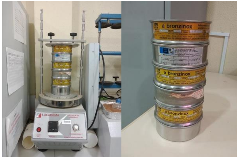
Figura 3. Agitador (A) e peneiras (B) com diâmetros de (>2,00 mm), (2,00 – 1,00 mm), (1,00 – 0,500mm), (0,500 – 0,250 mm), (0,250 – 0,106 mm) e (<0,106 mm) utilizadas na separação dos sedimentos
